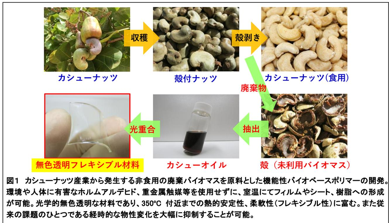
図1 カシューナッツ産業から発生する非食用の廃棄バイオマスを原料とした機能性バイオベースポリマーの開発。環境や人体に有害なホルムアルデヒド、重金属触媒等を使用せずに、室温にてフィルムやシート、樹脂への形成が可能。光学的無色透明な材料であり、350°C 付近までの熱的安定性、柔軟性(フレキシブル性)に富む。また従来の課題のひとつである経時的な物性変化を大幅に抑制することが可能。
